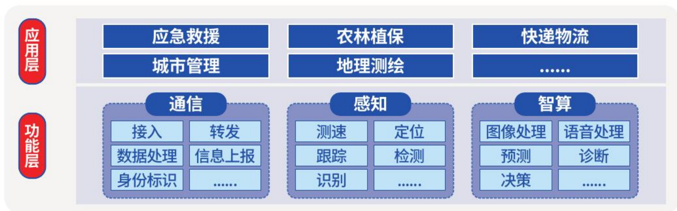
图8-低空网络功能架构
