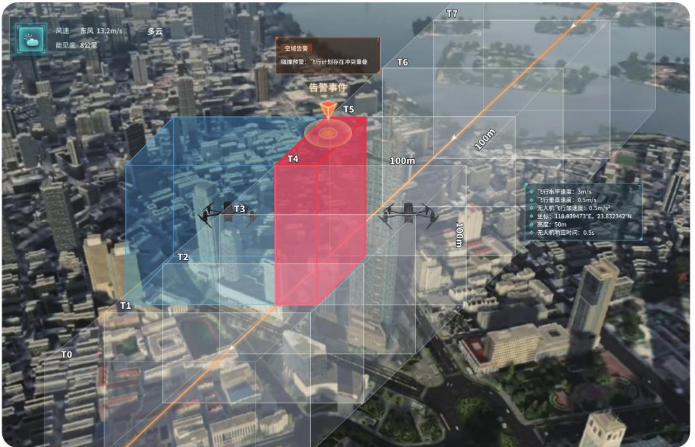
图21-无人机缓冲区碰撞效果
