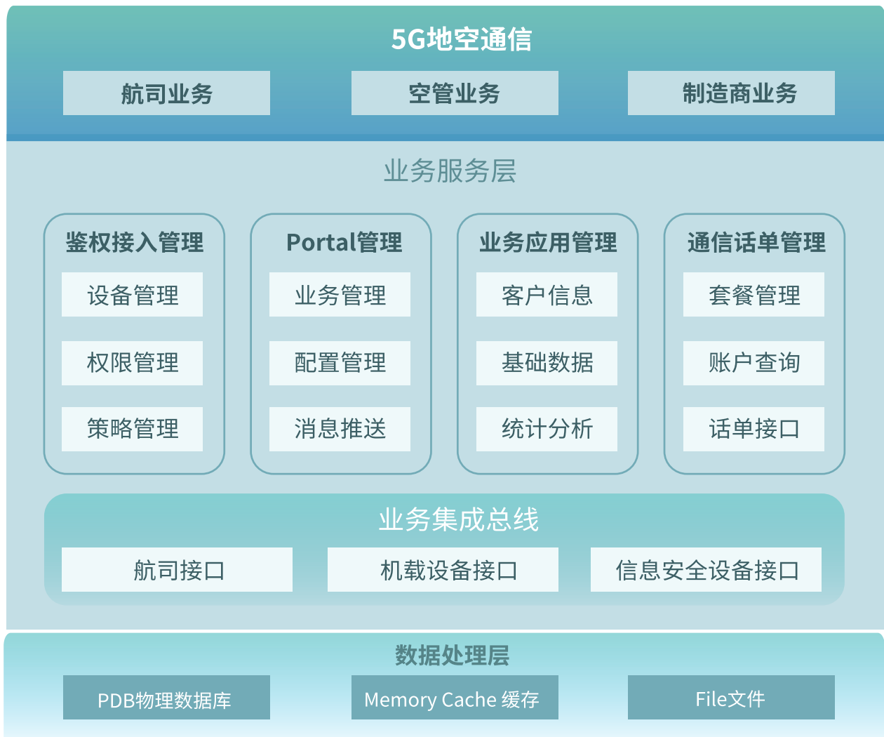
图2-7 5G地空通信业务平台功能架构
