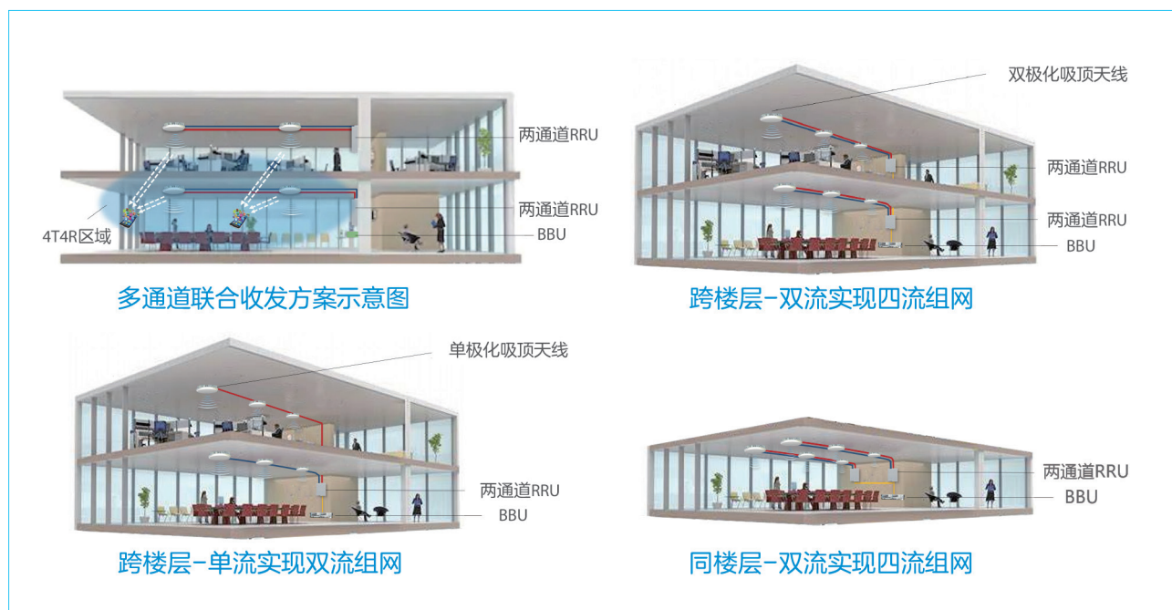
图 3-3 DAS 多通道联合收发方案示意图及 3 种典型场景
