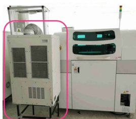
回流炉配置独立冰水机及抽风罩
