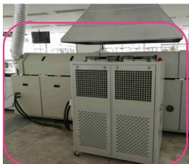
回流炉配置独立冰水机及抽风罩
