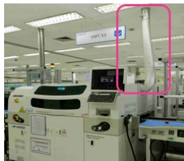
回流炉接入中央空调冷冻水
